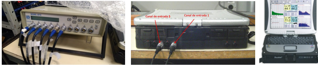
Figura 3. Sistema SB: multiplexador, conexões Lemo traseiras do SB e aspecto frontal.
