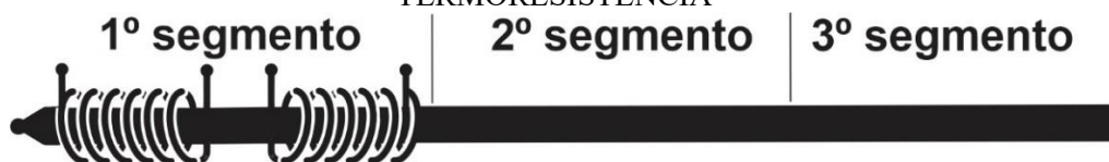
FIGURA 5 - DIAGRAMA DE DIVISÃO DA HASTE DA TERMORESISTÊNCIA
