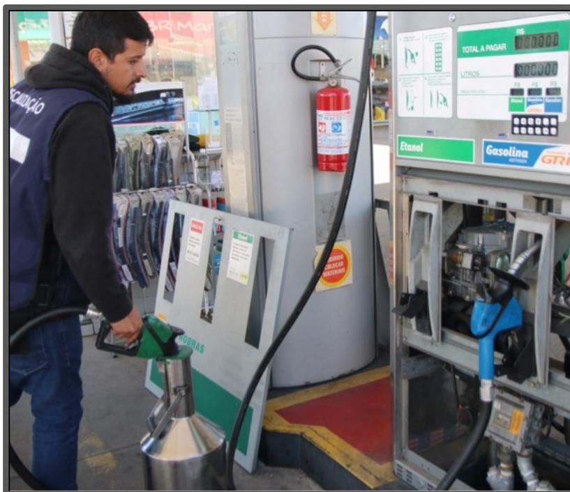
**Figura 3.** Agente fiscal verificando bomba medidora de combustível.
