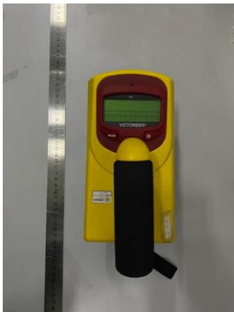
Figura 1 - Câmara de ionização de 600 cm<sup>3</sup> Fluke Victoreen, modelo 451B-RYR
