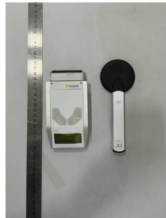
Figura 3 - Detector de estado sólido Unfors Raysafe, modelo U8201021-CX1
