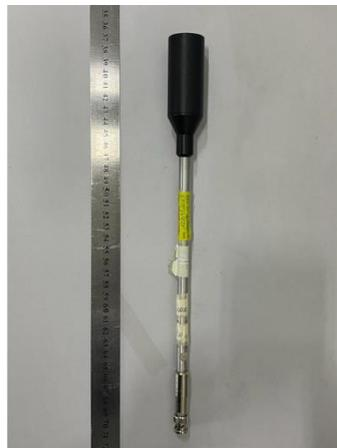
Figura 2 - Câmara de ionização cilíndrica PTW, modelo 23361
