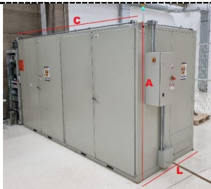
Figura 4. Imagem da estrutura utilizada para blindagem com dimensões de comprimento (C), altura (A) e largura (L).
