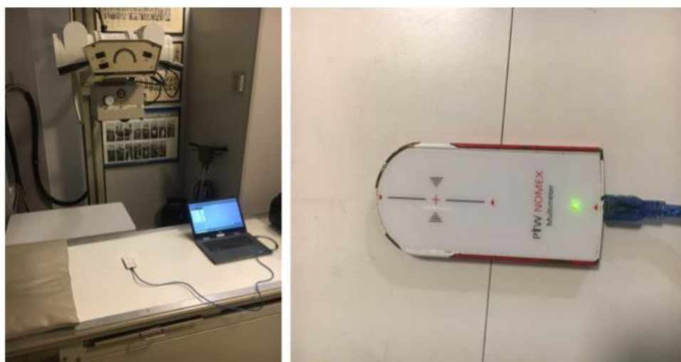
Figure 4 – Multímetro PTW NOMEX - testes de quilovoltagem e tempo de exposição
