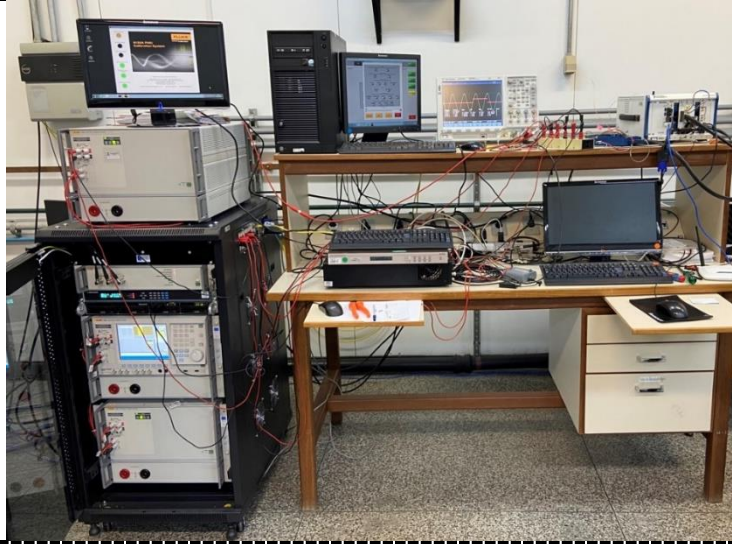
Figure 2. Fotografia do Sistema de referência para medição de sincrofasores no Lamel.
