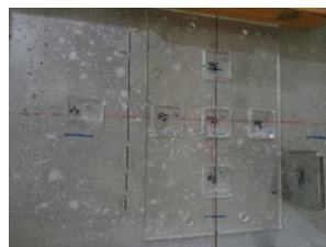
Figura 3: molde de acrílico para posicionamento das bags.
